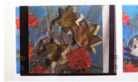
図 14 プリント画像上で視差を測定
